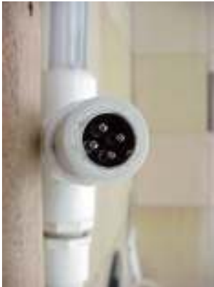
Transductor Mod. MPX 2102AP
