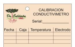
En la columna denominada "Caja" se anota el valor leído con la Resistencia de Calibración
